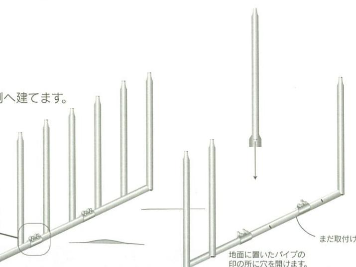
地面に置いたパイプの印の所に穴を開けます。
