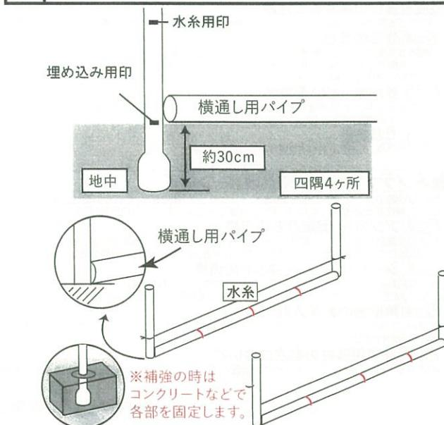
5 残りの脚用パイプを埋めます。(6本) 【注】横通しパイプの外側です。
