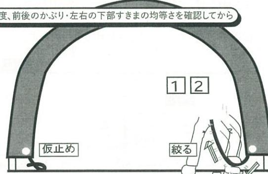
① 片方のU字杭からロープの仮止めをほどき、そのロープをU字杭を支点に、ロープをVの字に引き上げます。
