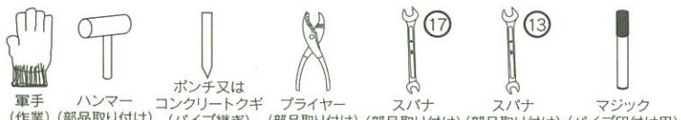
軍手 (作業) ハンマー (部品取り付け) ポンチ又は (パイプ接ぎ) コンクリートクギ (部品取り付け) ブライヤー (部品取り付け) スパナ (部品取り付け) マジック (部品取り付け) (パイプ印付け用)
