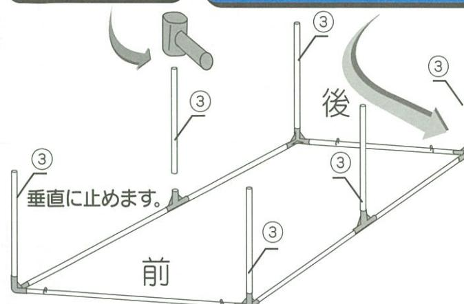
3 横通し用パイプを継ぎ、脚用パイプに差し込みます。
