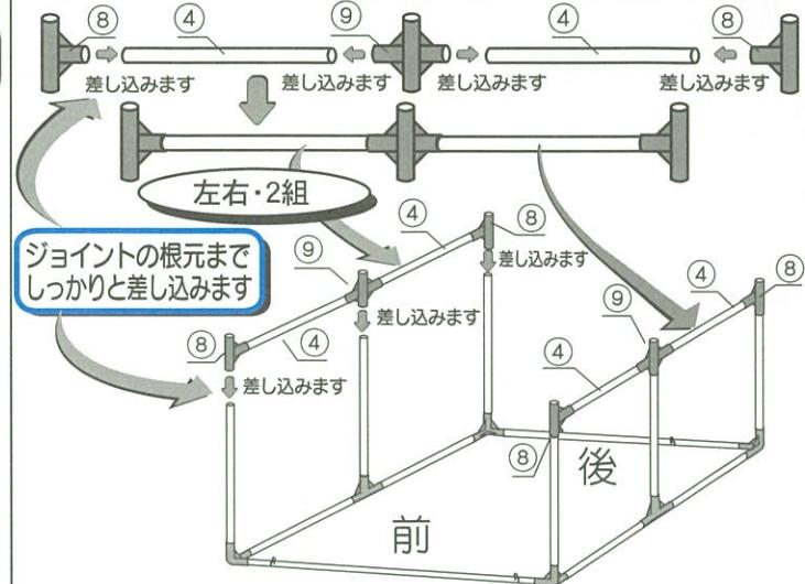
4 アーチ用パイプ・天井通し用パイプをパイプジョイント⑩・⑪に差し込み天井部を組立てます。
