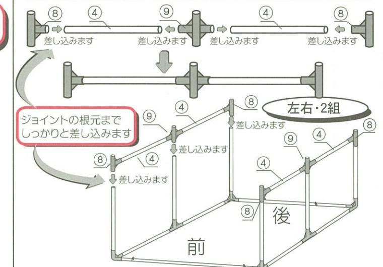
4 アーチ用パイプ・天井通し用パイプをパイプジョイント⑩・⑪に差し込み天井部を組立てます。
