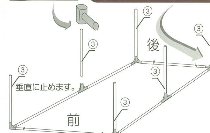
3 横通し用パイプを継ぎ脚用パイプに差し込みます。
