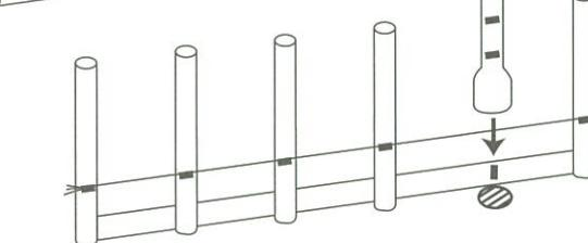
1. 横通し用パイプに付けた印(96cm間隔)の位置に約30cmの穴を掘ります。
