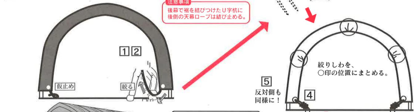
●天幕のバツキ防止の為、図のようにパイプとパイプの間をRバンドでしっかり結び止めて天幕をおさえてください。
