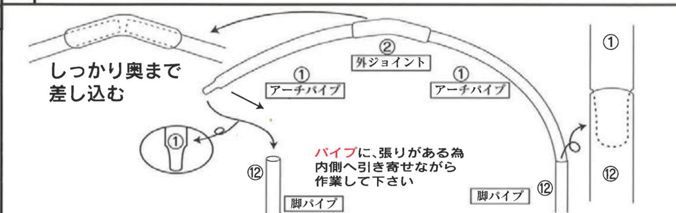
**7** **1**で準備した横通しパイプを取付ける。(内側に取付ける)
