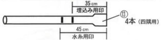
全ての継ぎ目を抜けない様につぶして下さい。(完成後、風などの揺れで、抜ける事が有ります。)
