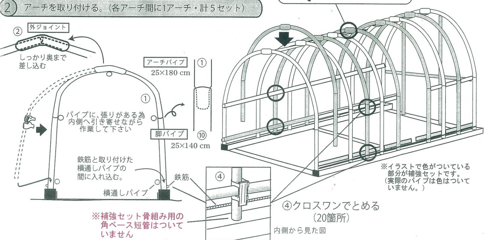
① 短管を後棲パイプに取り付ける
