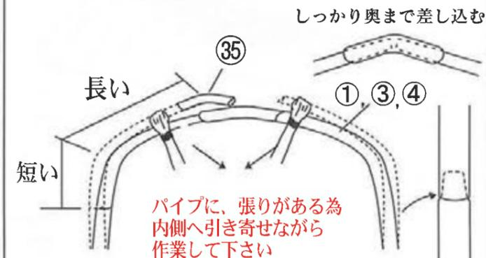
6 横通しパイプを継ぎ、印を付ける。(5組つくる。)
