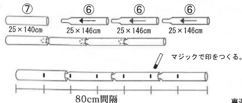
⚠ 全ての継ぎ目を抜けないようにする。(完成後、風などの揺れで、抜ける事が有ります)
