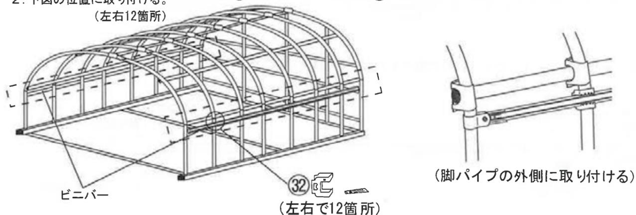
11 前部ツカパイプ、レールパイプを取り付け、前幕を取り付ける。
